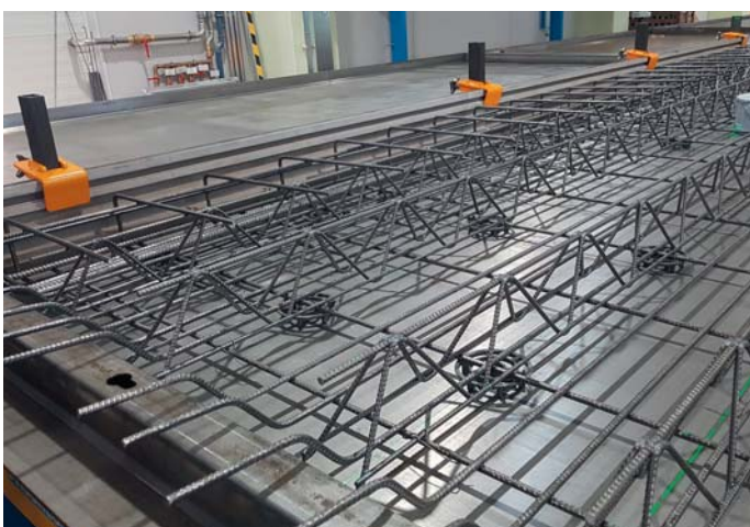
Glasfaseraufsatz zur Fixierung von Aufkantungen in der Elementdeckenproduktion
