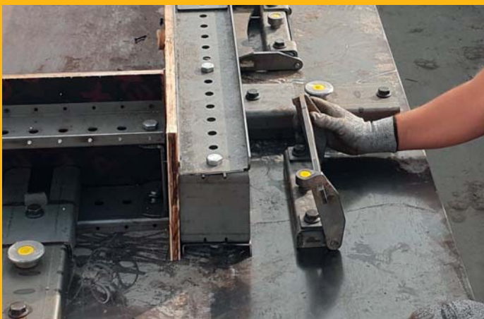
HT-Anschlagadapter in Position (rechts) – und gelöst (links)
