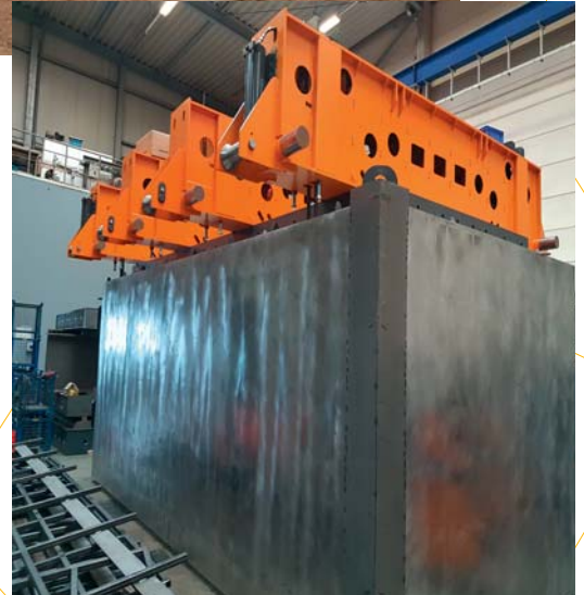
Ca. 35 Tonnen wiegt ein Innenkern der upcrete® Modulschalung für ein 25 m 2 großes Raummodul
