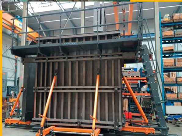
Mit nur einer Schalung lassen sich verschiedene Längen, Höhen und Formvarianten abdecken
