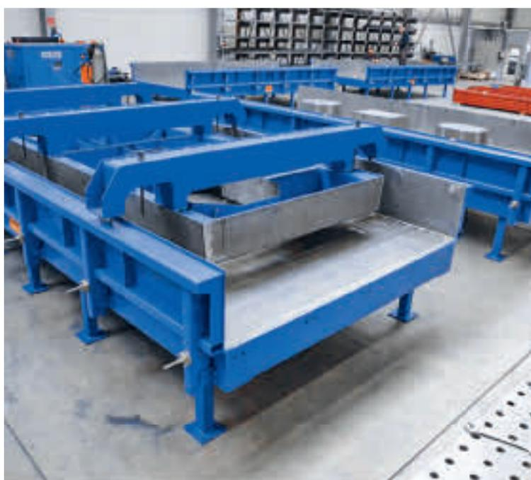
Los elementos de hormigón para funicular se deben producir con armadura descubierta. El encofrado se ha diseñado manera que las mesas se puedan seguir utilizando aun tras la «aplicación especial» para la producción de otros elementos.
