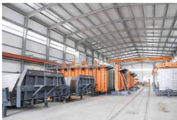
Moldes para módulos y techos en la instalación nueva en Ica
