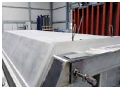
Llenado de prueba del molde para techos
