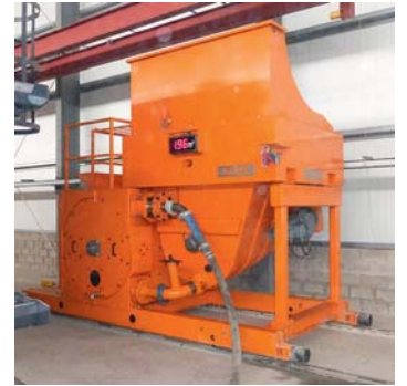
Carro de bombeo upcrete®, la estación de bombeo desplazable para una alimentación eficiente del hormigón.
