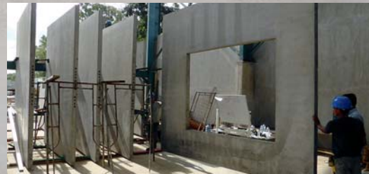
Indonesia: producción de elementos de fachada de 3,9 m x 9 m
