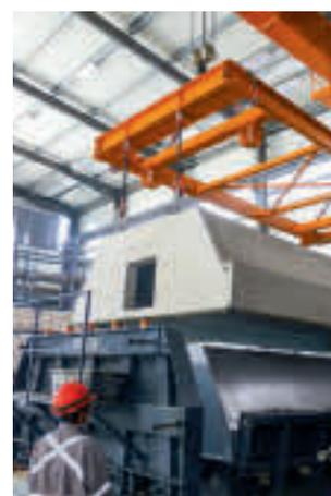
Exemple : Coffrage de toit pour upcrete®, pour un remplissage par le bas
