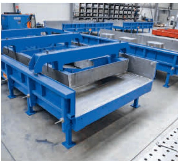
Les éléments en béton du funiculaire devaient être produits avec une armature saillante. Le coffrage été étudié de manière à ce que les tables puissent être réutilisées pour produire d'autres éléments après « l'utilisation spéciale ».
