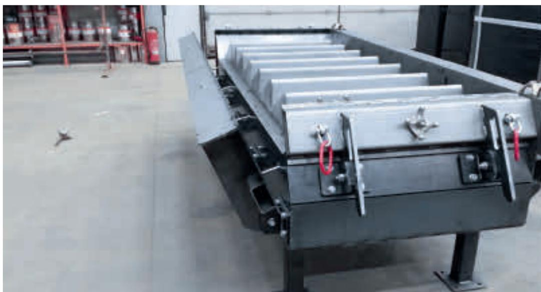
Solution spécifique pour moule d'escalier. Trois de ces formes d'escaliers ont été intégrées dans une palette tournante et suivent ainsi le circuit normal en usine.
